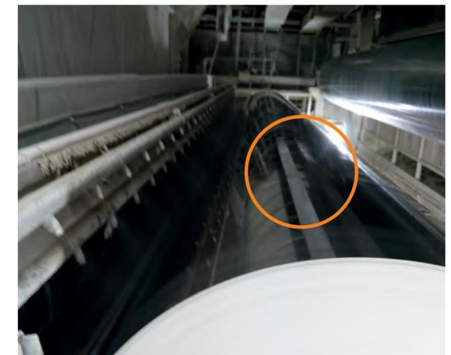
An diesem Speedcoater, Breite 7420 mm, wird holzhaltiges Druckpapier vorgestrichen. Die Gegenwalze wird mithilfe eines Spritzrohrs und eines Schabersystems gereinigt.
